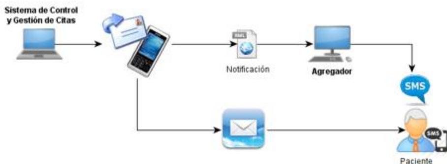
Como la Figura 1.3 muestra, el SICGC envía notificaciones por correo electrónico y mensajes SMS. El sistema genera un archivo en formato \*.xml con el texto de la notificación, y se envía por Internet al agregador. La empresa agregador se encarga de enviar la notificación al paciente mediante un mensaje SMS. Por su parte el sistema envía la notificación mediante correo electrónico al paciente.
